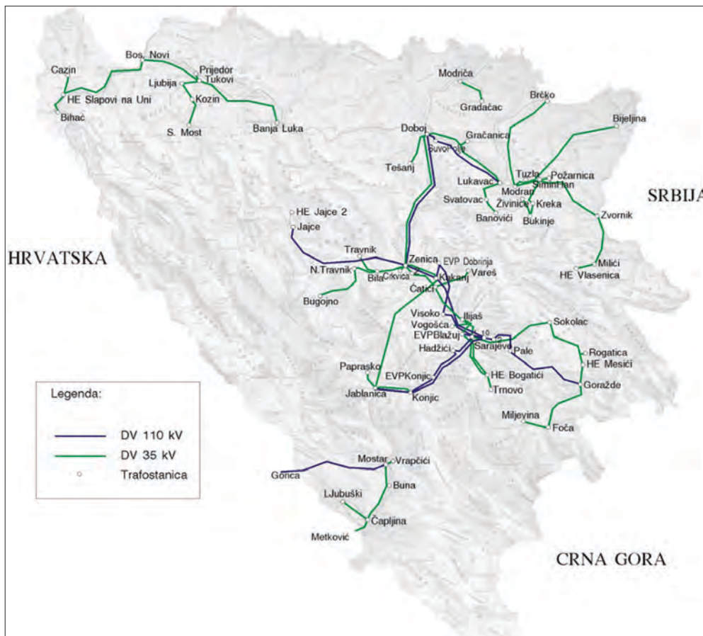
Slika 2.16 Prijenosna mreža 110 kV i 35 kV izgrađena do 1954. godine
