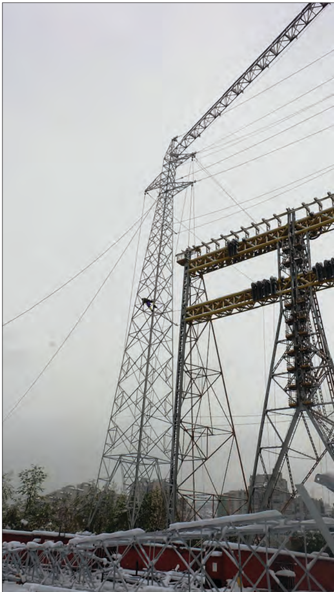
Slika 3.15 Energoinvestova ispitna stanica dalekovodnih stubova, Alipašić Most a) Priprema za ispitivanje (lijevo), b) Ispitivanje nosivosti dalekovodnog stuba (desno)
